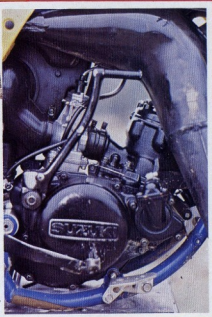
SUZUKI RM : inchangée (ou presque) trois ans de suite, la Suz avait besoin d'un lifting. Mieux que ça, c'est une toute nouvelle moto qui nous est proposée, véritable « copie » de la machine de Geboers. Pour forceurs ! Notez le boîtier de filtre à air grand volume et l'admission Power Reed.
