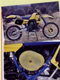
SUZUKI RM : inchangée (ou presque) trois ans de suite, la Suz avait besoin d'un lifting. Mieux que ça, c'est une toute nouvelle moto qui nous est proposée, véritable « copie » de la machine de Geboers. Pour forceurs ! Notez le boîtier de filtre à air grand volume et l'admission Power Reed.
